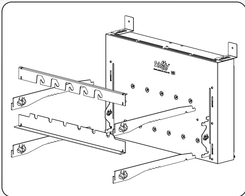
Retirar as peças móveis (cantoneira frontal móvel, cantoneira frontal invertida e os braços de apoio), facilitando o manuseio do equipamento para colocar na alvenaria.
