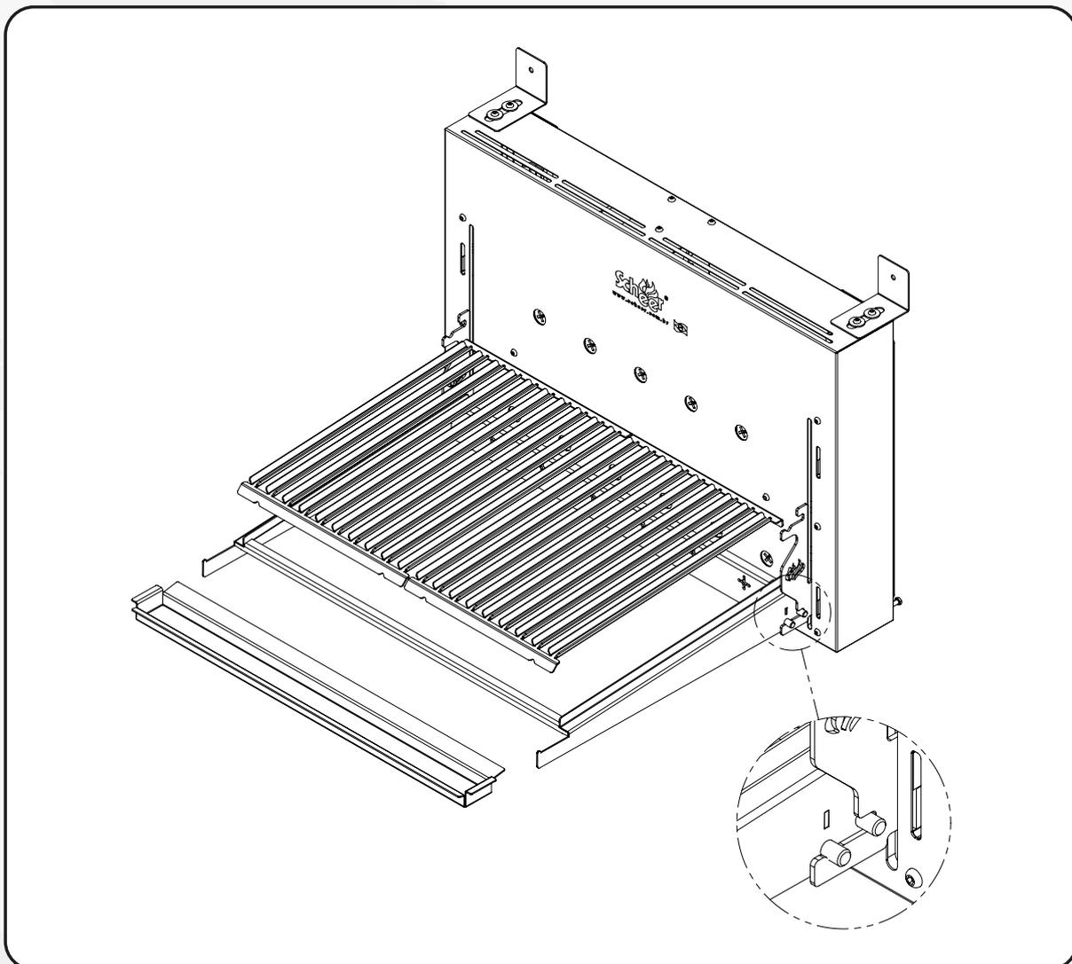
Para montar a grelha, inclinar o quadro no suporte lateral do gabinete, encaixando-o conforme o detalhe acima.
