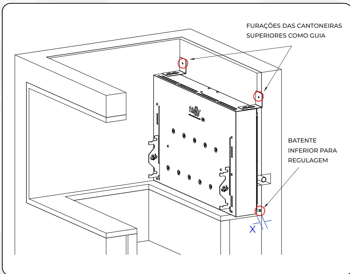
Com o equipamento na posição correta, deve-se marcar o local indicado na figura acima (cantoneiras superiores). Com o auxílio de uma trena, aferir a dimensão (X) entre a alvenaria e a churrasqueira, para posterior regulagem do batente inferior.
