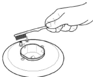
Limpeza do espalhador – Para limpeza do espalhador utilizar água morna e sabão. Após secar bem e posicioná-lo corretamente sobre o queimador.
